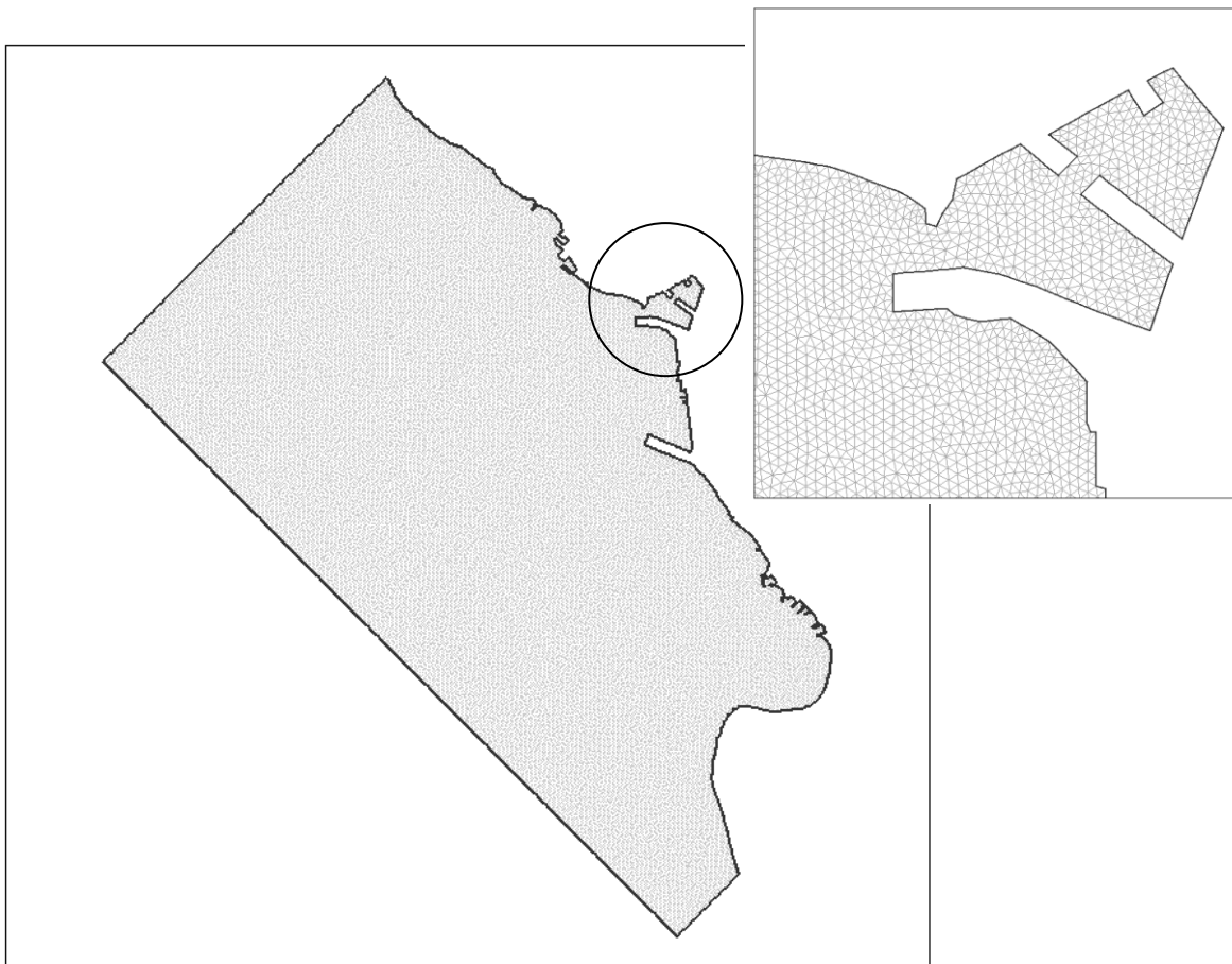
Slika 24. Domena modela za područje Prvić Luka - prikaz numeričke mreže konačnih elemenata
